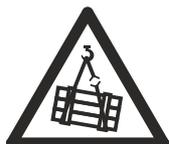
**Warnung vor schwebenden Lasten** Dieses Zeichen steht vor Tätigkeiten, bei denen eine Gefährdung durch schwebende Lasten besteht.
